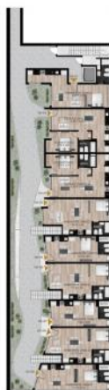
PLANTA BAJA 00 - 01 | MONDAMBIENTE Superficie: 34,2 m 2 00 - 02 | 1 DORMITORIO Superficie: 30,5 m 2 00 - 03 | 1 DORMITORIO Superficie: 30,5 m 2 00 - 04 | MONDAMBIENTE Superficie: 33 m 2 00 - 05 | MONDAMBIENTE Superficie: 34 m 2 00 - 06 | MONDAMBIENTE Superficie: 33 m 2 00 - 07 | MONDAMBIENTE Superficie: 30,5 m 2 00 - 08 | MONDAMBIENTE Superficie: 34,2 m 2 00 - 09 | MONDAMBIENTE Superficie: 34,2 m 2
