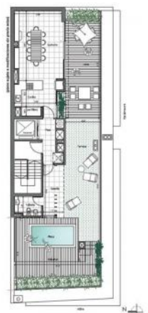
PLANTA AZOTEA ANEXOS Sector: Piscina, Baños, vestidores y rampa: 51.00m 2 Sector: Sala de máquinas: 21.00m 2 Sector: Terraza de 40.00m 2 Galería: 8.00m 2 Total: 120.00m 2 Póster Común: 17.00m 2
